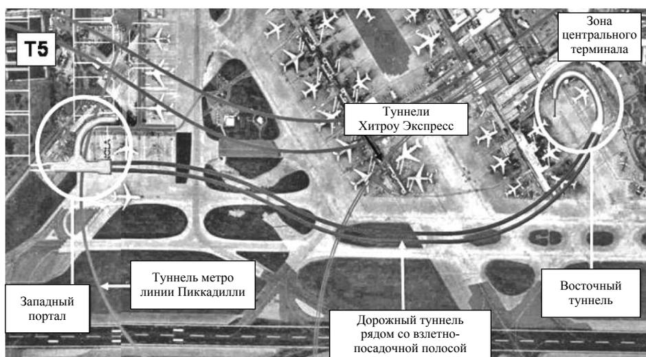
Рис. 2. План аэропорта Хитроу с туннелем ART
