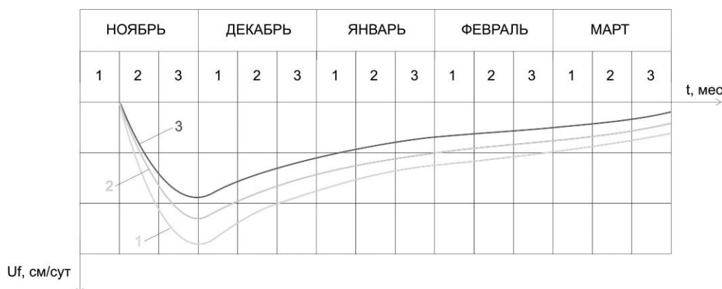
Рис. 1. Нормативные скорости промерзания грунта под снегом: 1 – при температуре 0°C; 2 – при T \leq -0,6^\circ\text{C} ; 3 – при T \leq -1,0^\circ\text{C}
