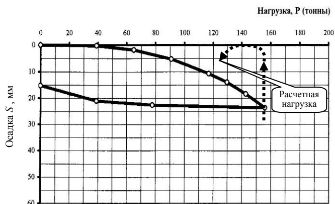
Рис. 2. Графическое представление результатов испытания сваи статической нагрузкой
