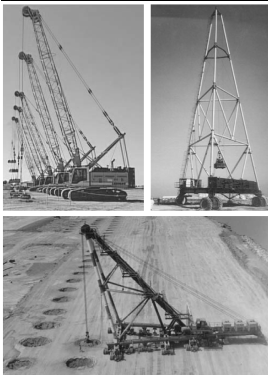
Рис. 1. Виды оборудования для тяжелого трамбования. Верхний левый рисунок: гусеничные краны; верхний правый рисунок: вышка; нижний рисунок: гига-машина
