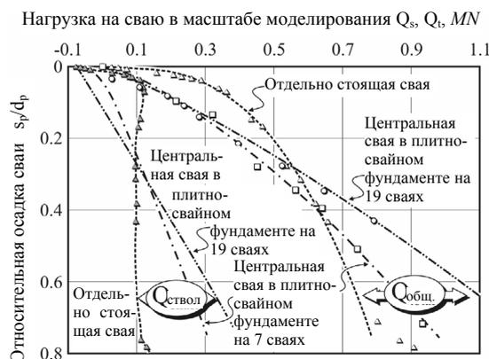
Рис. 12. Сравнение работы центральной сваи под плитой и отдельно стоящей сваи
