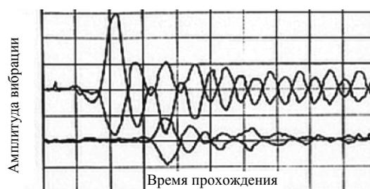
Рис. 4. Испытание на обратное воздействие в рамках сейсмического испытания вертикальных скважин для определения времени первого прибытия
