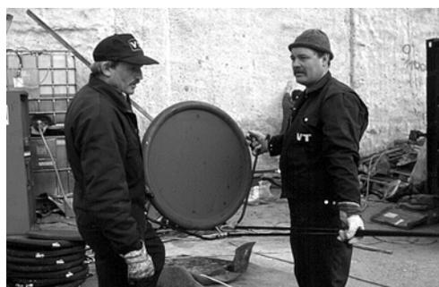
Рис. 13. Плоские домкраты для предварительного нагружения свай (к рис. 11, 12)
