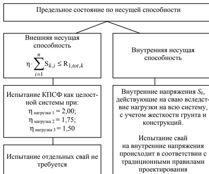
Рис. 14. Рекомендация по строительству КПСФ: Определение предельного состояния
