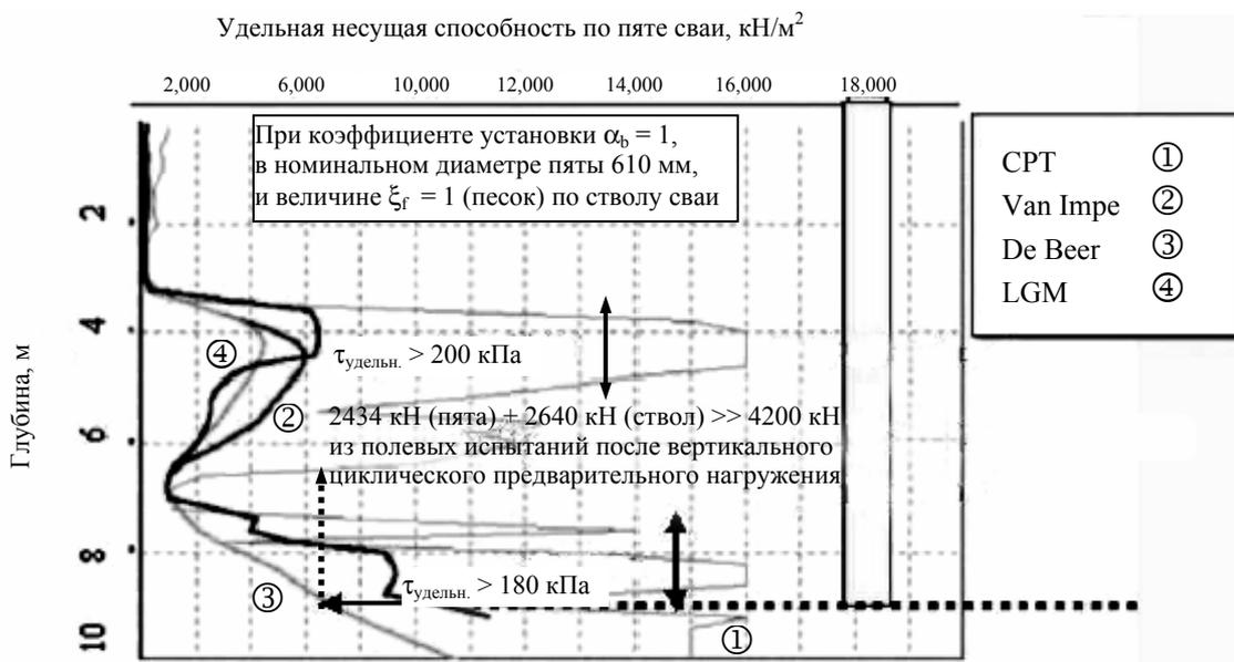
Рис. 41. Прогноз несущей способности по пяте и стволу сваи традиционными методами на основании СРТ (тип С). Несущая способность по пяте рассчитана тремя методами (De Beer, Van Impe–De Beer, LGM) с использованием результатов СРТ в месте устройства сваи TP1
