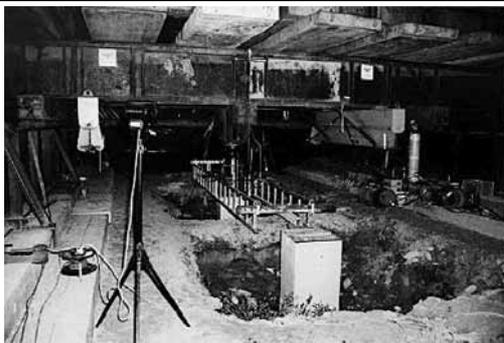
Рис. 22. Площадка SKW: Испытания на статическую нагрузку
