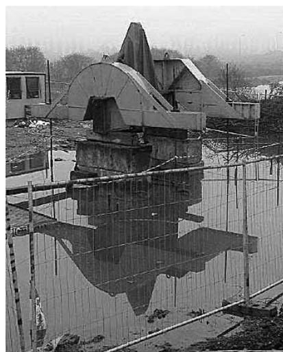
Рис. 38. Экспериментальное оборудование для нагружения винтовых свай
