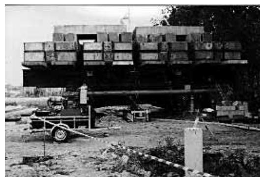
SKW – Система роликового нагружения весом 350 т
