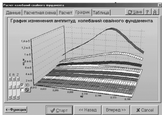
Рис. 4. Окно вывода графика изменения амплитуд колебаний свайного фундамента в зависимости от частоты (трехмерное представление графика)
