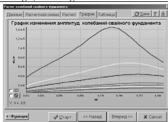
Рис. 5. Окно вывода графика изменения амплитуд колебаний свайного фундамента в зависимости от частоты (двумерное представление графика)
