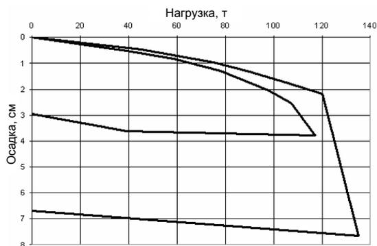
Рис. 7. Результаты испытания двух свай в 1969 г.
