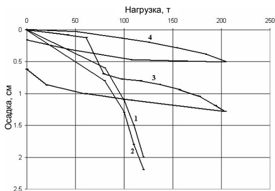
Рис. 9. Результаты испытания свай после погружения (1, 2) и после работы в основании конструкций через 1,5 года (3, 4)
