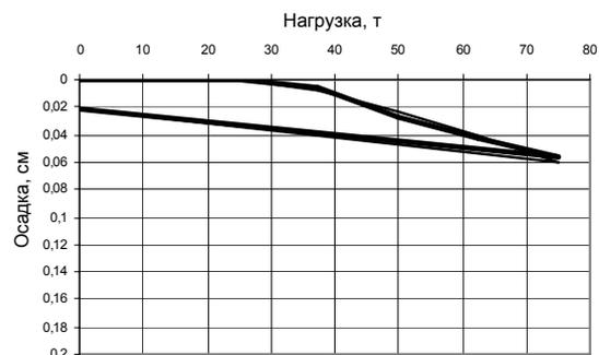
Рис. 6. Результаты испытания двух свай в конструкции через 30 лет
