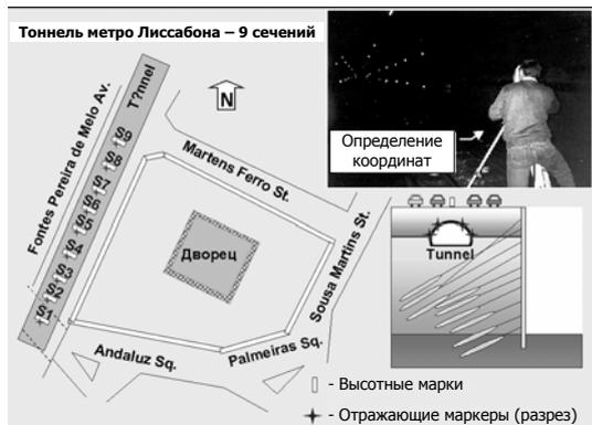
Рис. 9. Мониторинг и обследование тоннеля метро Лиссабона и основные окончательные показатели
