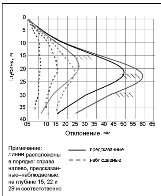
Рис. 22. Изгиб стены в грунте
