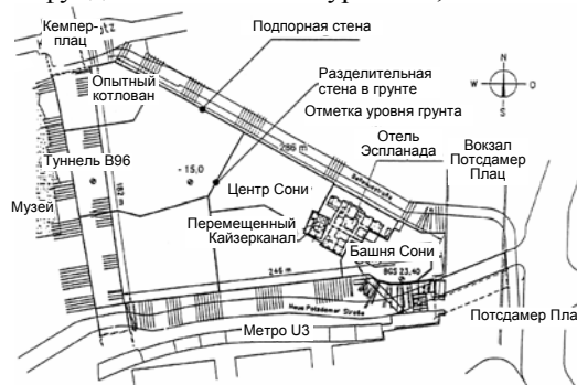
Рис. 19. Общий план котлована для центра Сони
