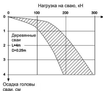
Рис. 12. Испытание деревянной сваи статической нагрузкой
