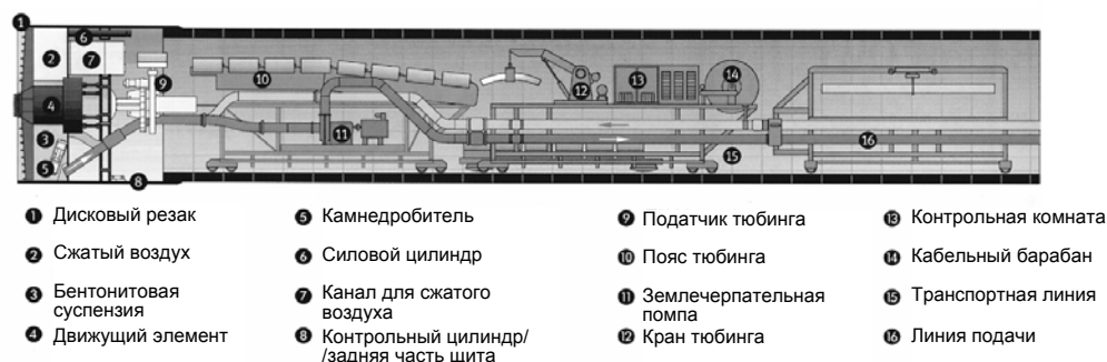
Рис. 32. Комбинированный туннелепрокладчик
