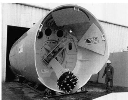
Рис. 36. Щит из сжатого воздуха – компания «Бессак»
