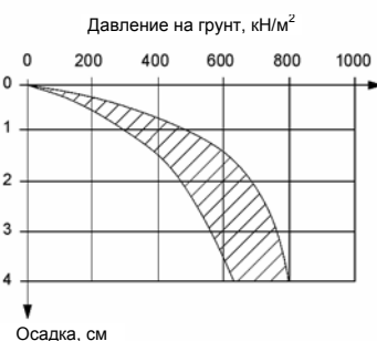
Рис. 13. Испытание статической нагрузкой жесткого штампа
