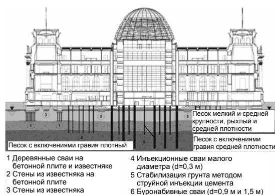
Рис. 14. Поперечное сечение с элементами фундамента
