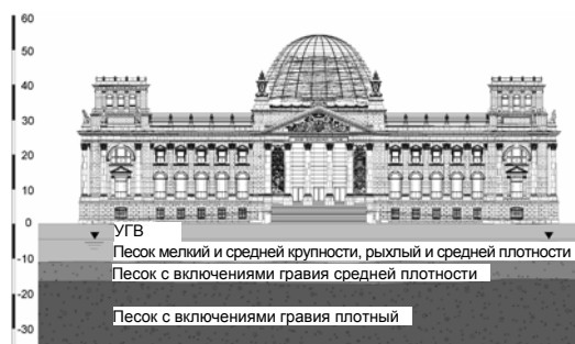
Рис. 8. Геотехническая ситуация под зданием Рейхстага
