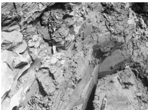
Рис. 2. Характер интенсивности трещиноватости нижекембрийских глин в свежем борту карьера «Красный Бор» в Ленинградской области
