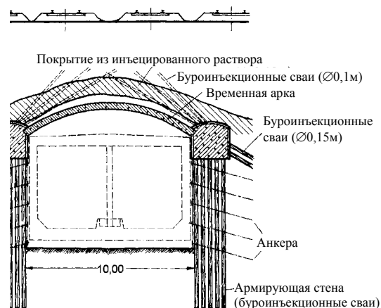
Рис. 16. Прокладка тоннеля под железнодорожной насыпью
