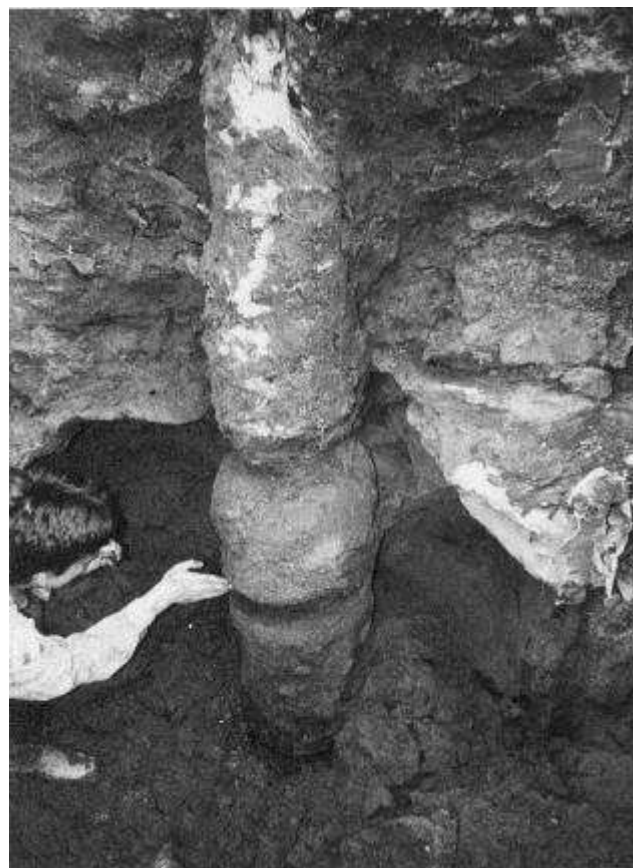
Фото 2. Опытная площадка п. Ольгино - свая диаметром 0,45м.
