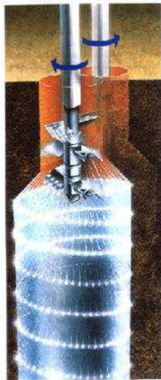
Рис. 5 Комбинация буросмесительного и струйного способа устройства колонн закрепленного грунта
